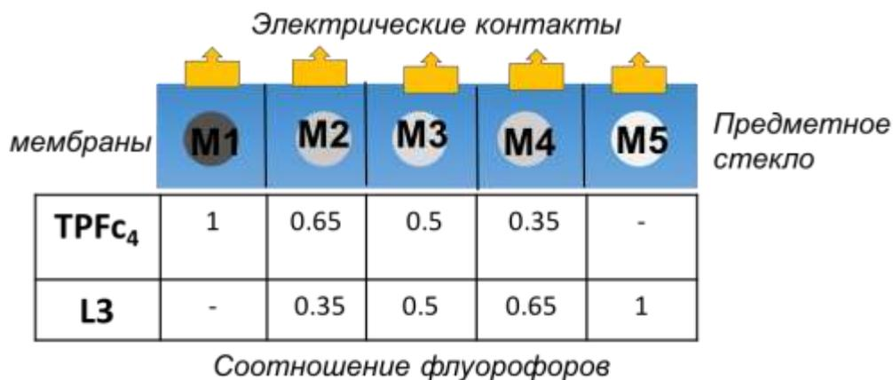
**Рис.VIII.20.** Схематическое представление аналитической системы для мониторинга загрязнения природных вод на основе флуорофоров TPFc<sub>4</sub> и L3.
