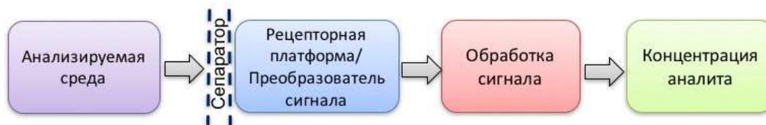
**Рис. I.3** Схематическое представление сенсорной системы [13].
