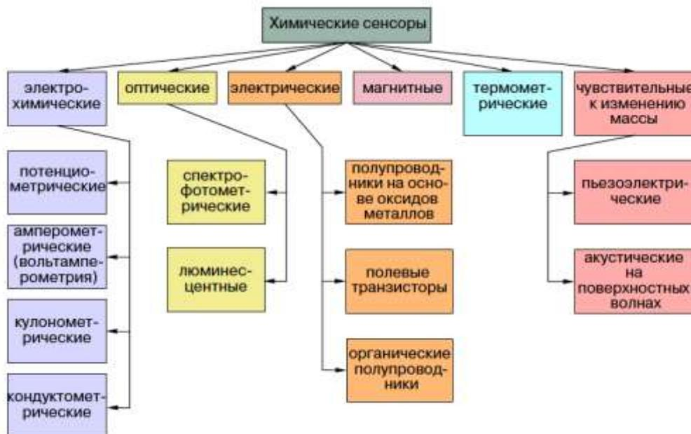
**Рис. 1.6** Классификация химических сенсоров, из работы [17].
